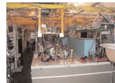
Figure 2. Une partie de la chaîne qui a permis de mesurer jusqu'à très récemment au LPTF des fréquences dans le domaine optique
